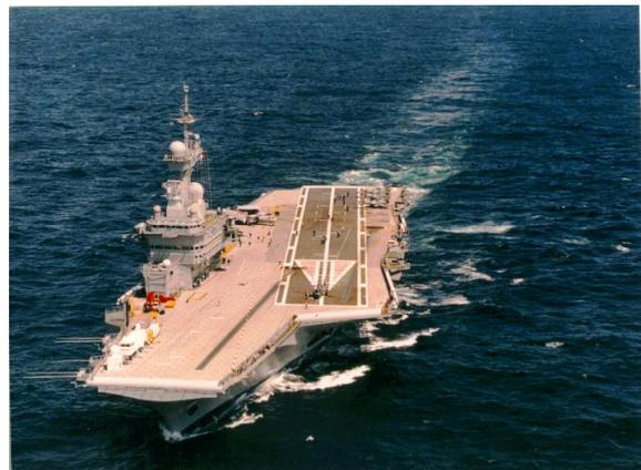
FIGURE 2 – Pont du porte-avions : position des pistes de décollage et d'appontage.
