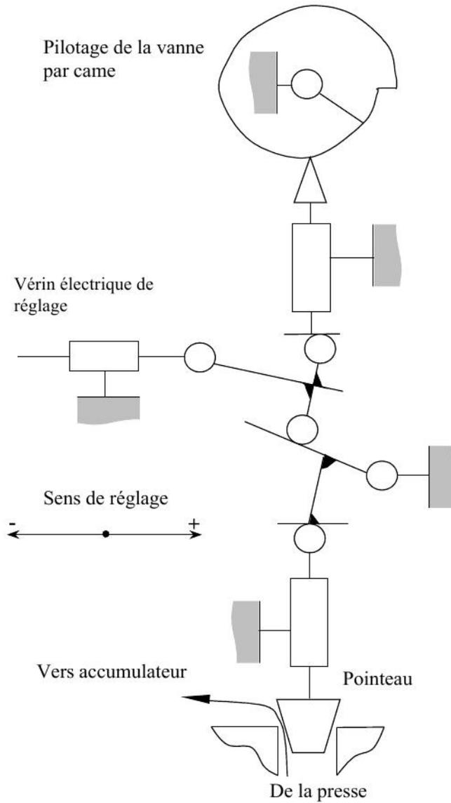
FIGURE 11 – Schéma cinématique de la vanne de laminage.
