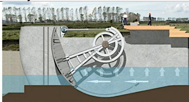
2) Heure marée haute – 1h : Les vannes fermées retiennent les sédiments du côté mer du barrage
