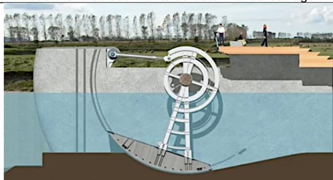
4) Pleine mer : ouverture complète des vannes le temps nécessaire au remplissage du Couesnon
