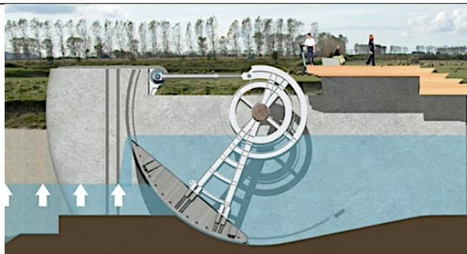
3) Pleine mer – 10 min : ouverture des vannes en « sur verse » pour remplir la rivière d'une eau sans alluvion
