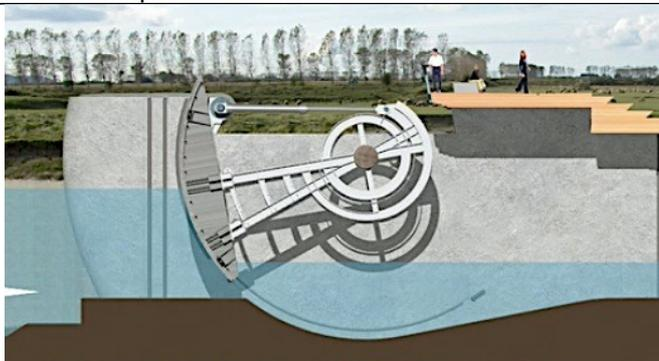
7) Marée haute + 6h : ouverture des vannes en « sous verse », effet de chasse des eaux du Couesnon libérées et élimination des alluvions de la baie
