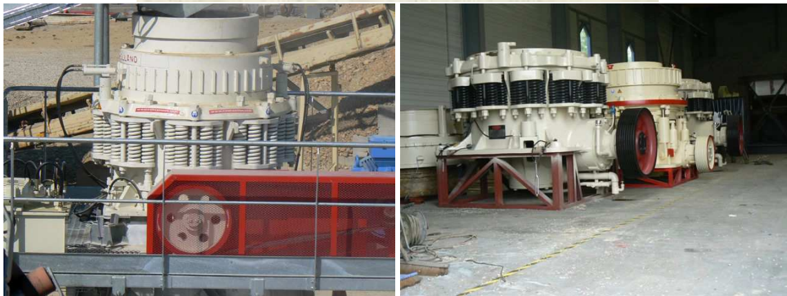
FIGURE 1 – Installation de concassage et criblage mine d'or AKKA GOLD MINING utilisant 2 broyeurs à cônes ROC 900 SH.
