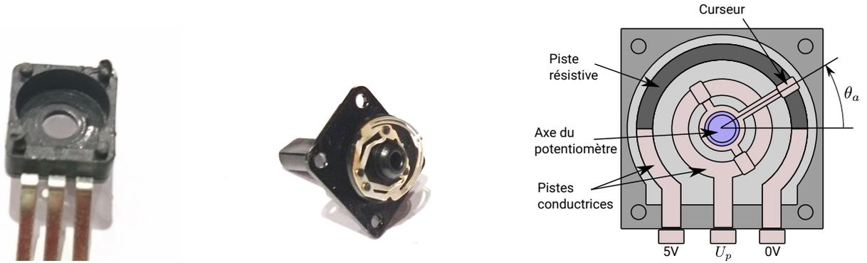
FIGURE 7 – Potentiomètre démonté et représentation schématique
