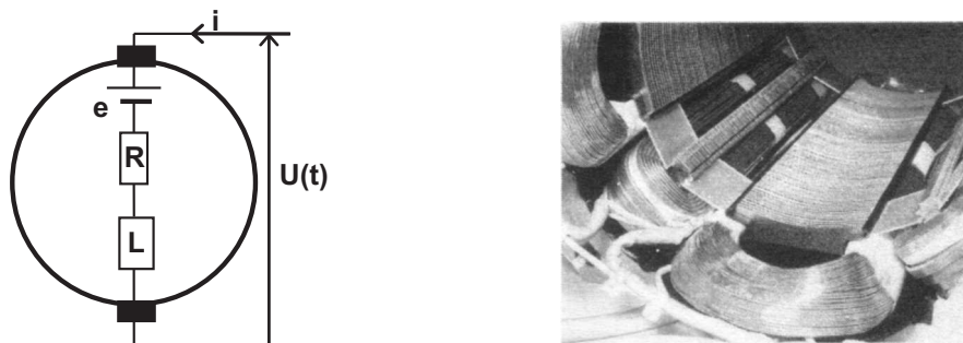
FIG. 3 – Modélisation électrique du moteur à courant continu et photo du circuit induit.
