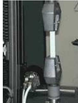
FIG. 2 – Éprouvette dans les mors de la machine.
