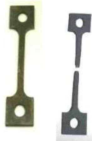
FIG. 3 – Éprouvettes avant et après essai.
