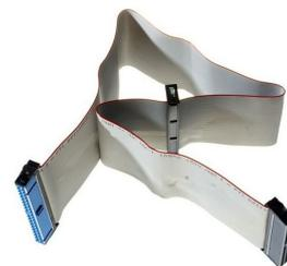
Le bus SATA ou S-ATA (Serial ATA) a été conçu afin de pallier aux problèmes de diaphonie constatés à haute fréquence sur le bus IDE encore appelé Parallel ATA.
