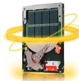
Actuellement, l'un des disques de plus grande capacité est le Seagate Laptop SSHD 1 To avec SSD 8 Go en MLC. On trouve également dans la marque Western Digital le WD Black SSHD, 1 To en stockage classique et 24 Go de mémoire NAND Flash.
