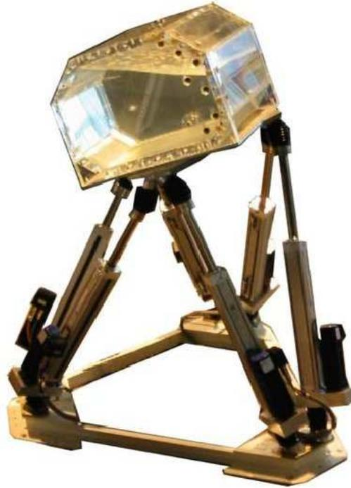
FIG. 1 – Plate-forme hexapode équipée d'une maquette de cuve de méthanier.
