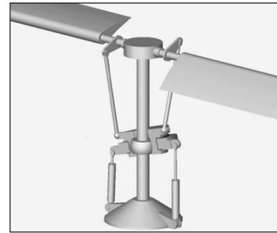
FIGURE 2 – Hélicoptère à l'arrêt. Les pales sont en position horizontales (incidence nulle).
