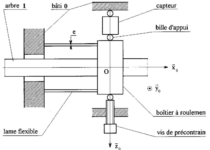
L'arbre 1 (avec la poulie), de masse  $m_1$ , a pour moment d'inertie  $I_1$  par rapport à l'axe  $(O, \bar{x}_0)$  et est équilibré en rotation.
