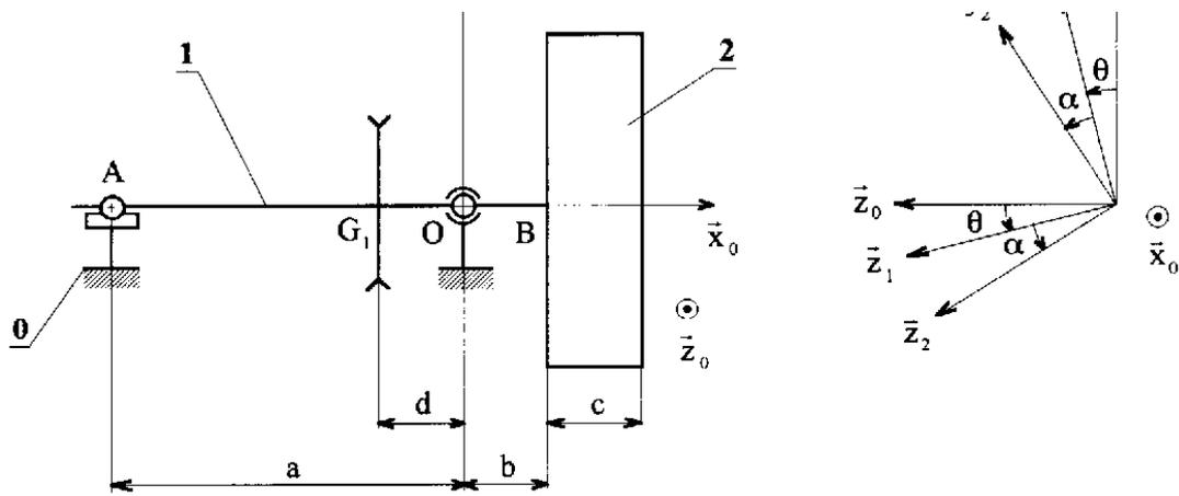
Le repère  $R_0 (O, \bar{x}_0, \bar{y}_0, \bar{z}_0)$  est lié au bâti 0 ( $\bar{y}_0$  vertical ascendant).
