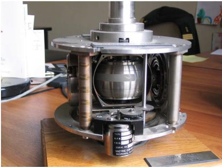
FIGURE 6 – Vue globale du gyromètre.
