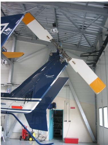
FIGURE 35 – Rotor arrière de l'hélicoptère, tournant à 2000  $tr/min$ .
