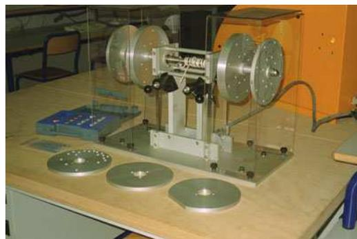
FIGURE 40 – Banc d'équilibrage du laboratoire de SI.
