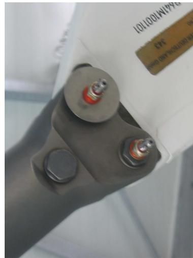
FIGURE 36 – Montage des masselottes sur le rotor en quatre points.
