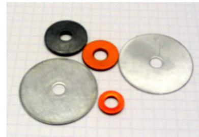
FIGURE 37 – Masselottes de masses calibrées pour l'équilibrage.
