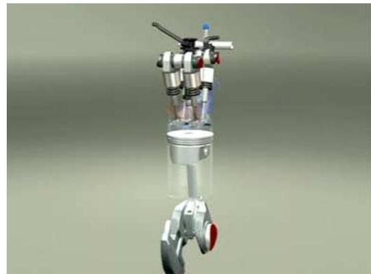
FIGURE 2 – Vue d'un unique cylindre, avec le système bielle-manivelle et les soupapes.
