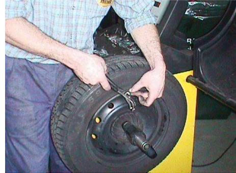
FIGURE 34 – Mise en place au marteau d'une masselotte sur la jante.
